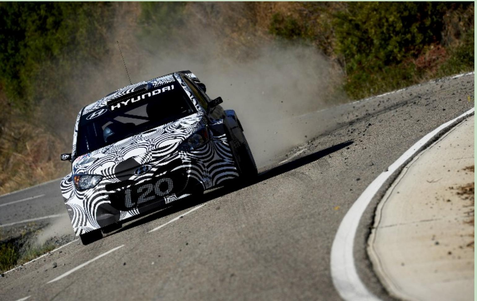
centro di ricerche Hyundai a Namyang. Bertrand Vallat, il nostro progettista capo, ha migliorato l'auto soprattutto dal punto di vista dell'affidabilità cercando di sviluppare quanto possibile rispettando le scadenze imposte. Ha riprogettato le sospensioni, mantenendo la trasmissione X-Trac. Per il motore siamo ripartiti dal monoblocco e la testata elaborate a Namyang e sul quale abbiamo migliorato distribuzione, aspirazione e scarico con l'aiuto del nostro partner tecnico Pipo Moteurs.
